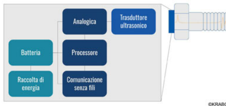
Fig. 2: Schema a blocchi di una vite KRABO®. Il trasduttore ultrasonico è eccitato dall'elettronica che, pilotata dal processore, permette di ottenere la misura e di comunicarla senza fili tramite l'apposito modulo. Pubblicata con permesso da [14].
